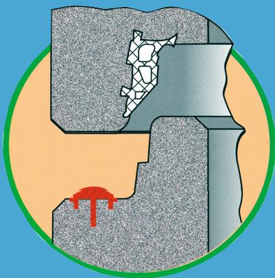
Ausschnitt: Drei-Punkt-Auflager (rot) mit integrierter Dichtung in der Muffe
