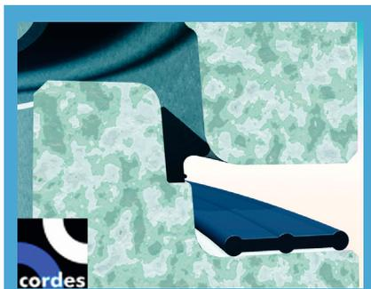
Keildichtung SD 97 mit Lastausgleichselement CLE
